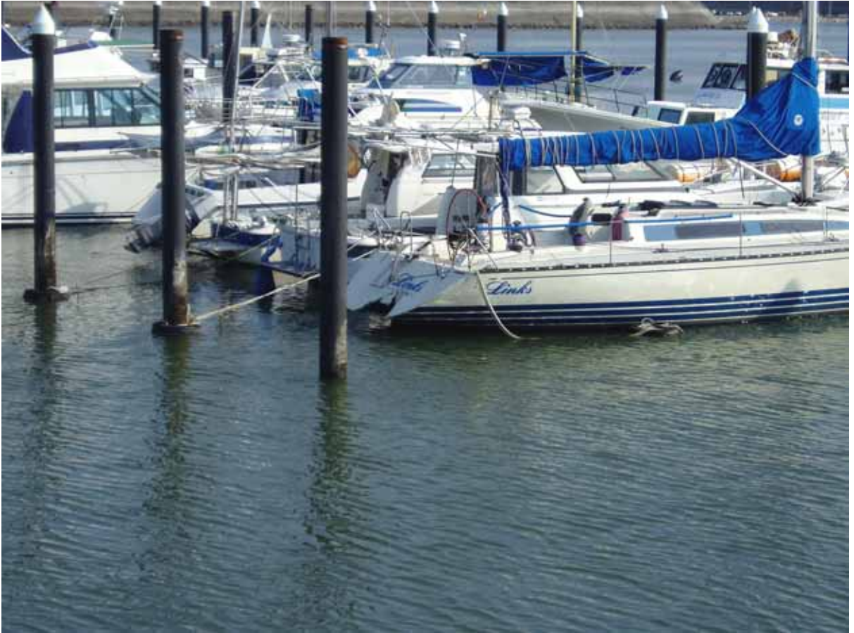
1号桟橋 繫留環が抜けスターンが繫留杭にぶつかり穴が明いたヨット
